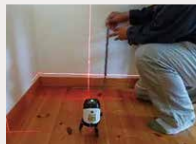
「床の傾きを計測する」調査機器
